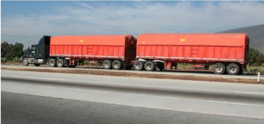
**Figura 1. Configuración Doblemente Articulada T3-S2-R4 (FULL)**
