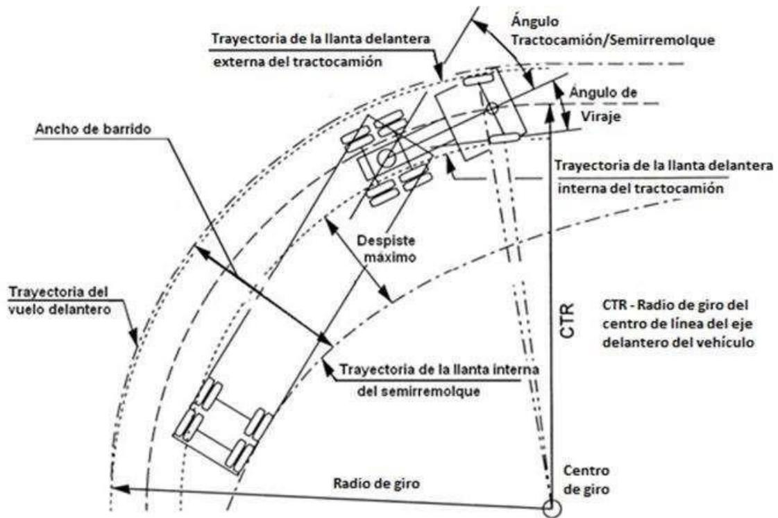
**Figura 1 - Ampliación de un tractocamión articulado. Trayectorias, radio de giro, despiste máximo y ancho de barrido [8].**
